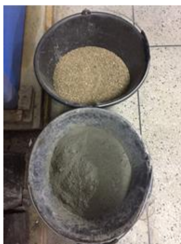
Figura 3: Cimento e agregado miúdo natural (areia) para referência
