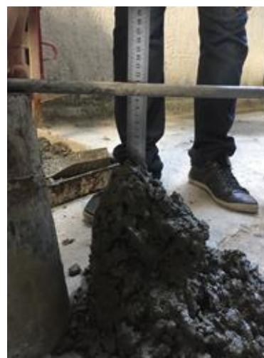
Figura 5: Ensaio de abatimento do tronco de cone “slump test”
