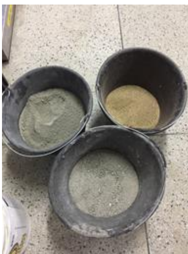
Figura 4: Cimento e agregado miúdo (50% areia + 50% resíduo) substituição
