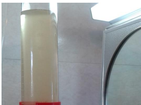
Figura 9 - Água amarelada e com ferrugem (apartamento 2º pav.). Fonte: Autor: Ágatha Canellas.
