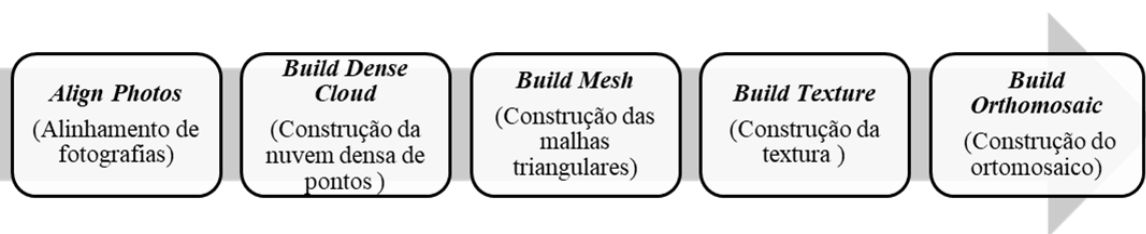
Figura 6: Sequência de produção de ortomosaicos
