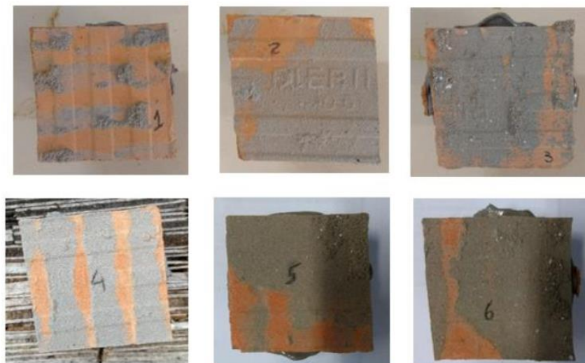
Figura 17 - Tardozes dos CP's após a execução do ensaio
