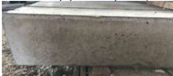
Figura 1 - Bolhas na lateral da peça com o traço 1:3:4 (cimento:areia:brita 01)
