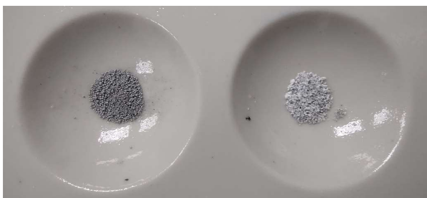
Figura 5 – Amostras de sílica ativa expostas em álcool isopropílico (à esquerda) e em NaOH (à direita)
