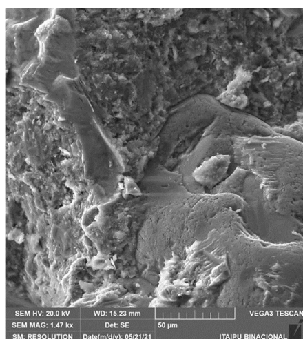
Figura 1 – REF-H 2 O: região entre pasta e agregado aos 30 dias de idade
