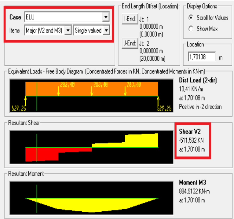
Figura 4 – Diagrama de momento fletor e cortante
