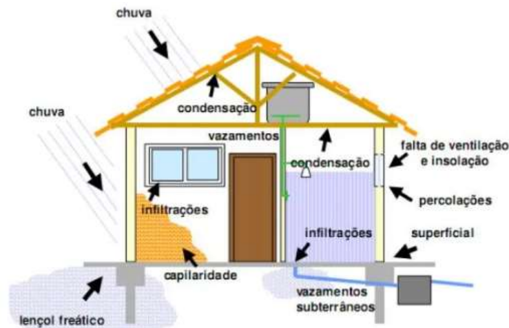
Figura 1. Causas de umidade nas edificações
