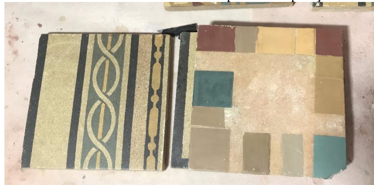
Figura 13 – Testes de uniformidade de cores para recomposição dos ladrilhos.
