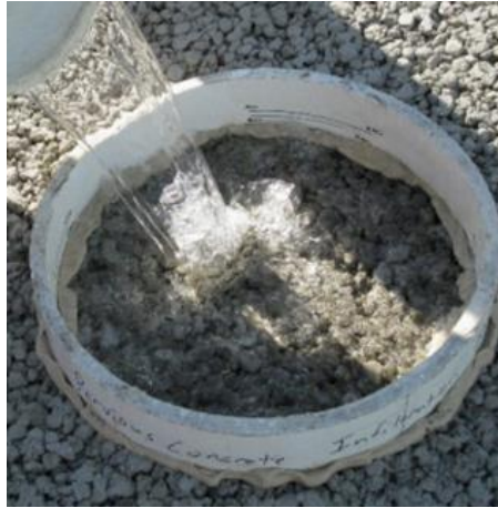
Figura 2. Ensaios de permeabilidade
