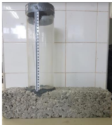
Figura 3. Ensaio de permeabilidade adaptado da ABNT NBR 16416 (2015). Anel de 100mm de diâmetro, vedadona junção com o concreto permeável pela massa de calafetar.
