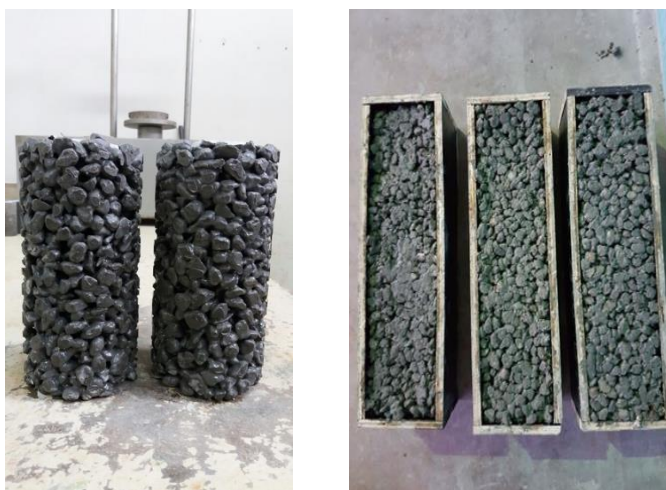
Figura 1: Moldes de concreto permeável. a) cilindros (10x20cm) b) prismas (10x10x40cm).
