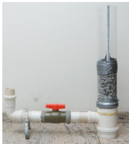
Figura 3. Aparelho de ensaio de permeabilidade segundo a ACI 522 – R: 2010
