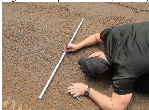
Figura 7 - Medições das flechas (deflexões)
