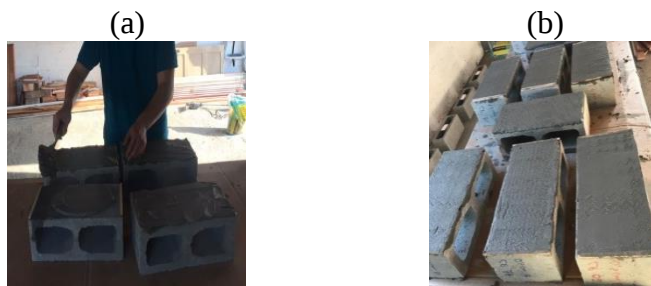
Figura 1: (Submeta II-A): (a) umedecendo os corpos de prova, (b) gabaritos, (c) corpos de prova aguardando tempo de cura.
