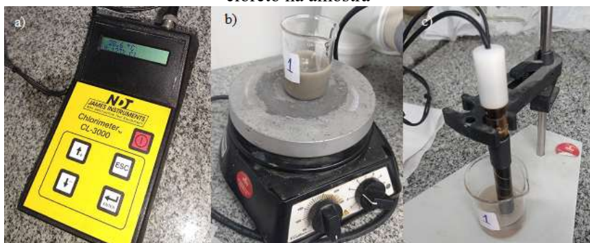
Figura 3 – a) Aparelho de medição b) Homogeneização da amostra c) Aferição da concentração de íons cloreto na amostra
