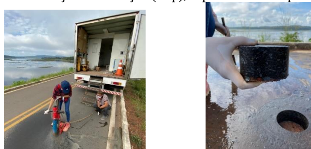
Figura 01 – Execução da extração (esq.), aspecto do furo após extração (dir.).
