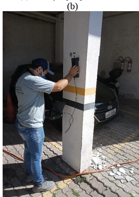
Figura 6. (a) Extração de testemunho de concreto e (b) avaliação por pacometria.
