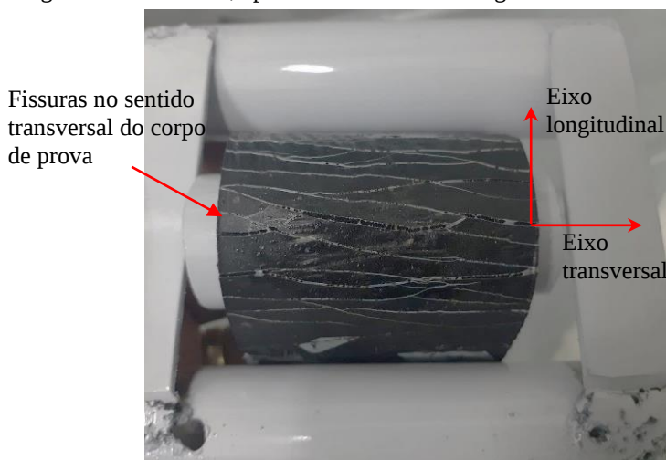
Figura 10 - Ensaio de flexibilidade a baixa temperatura de manta asfáltica, tipo II, classe B, com acabamento com grânulos de ardósia, apresentou fissuras ao longo de toda a extensão da amostra.
