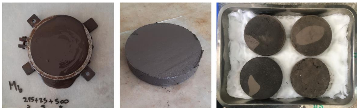
Figura 7- Ensayos de probetas con consolidante e hidrofugante
