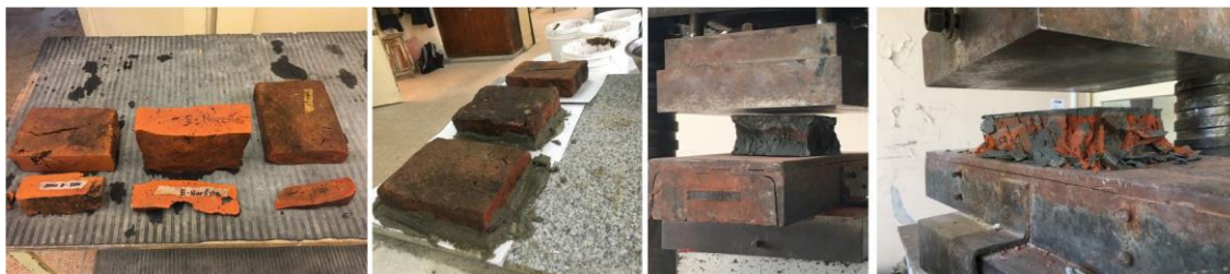
Figura 6 – Preparación y ensayo de rotura a compresión de ladrillos
