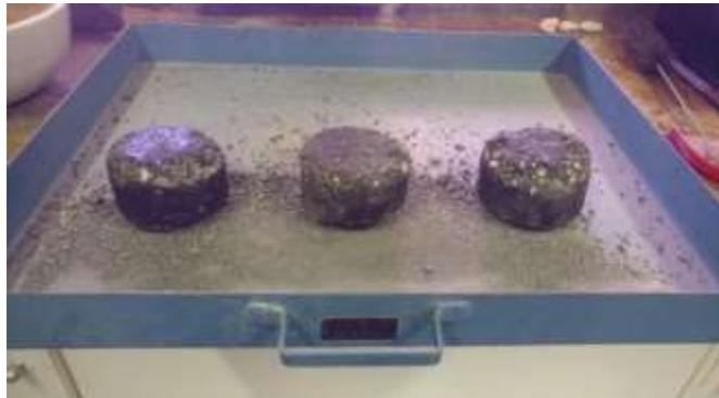
Figura 1- CP 100% RAP após desgaste Cantabro (Autor 2020).
