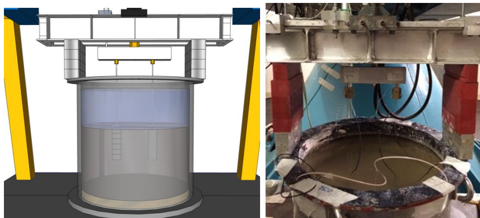
Figura 4. Ensaio de arrancamento das estacas
