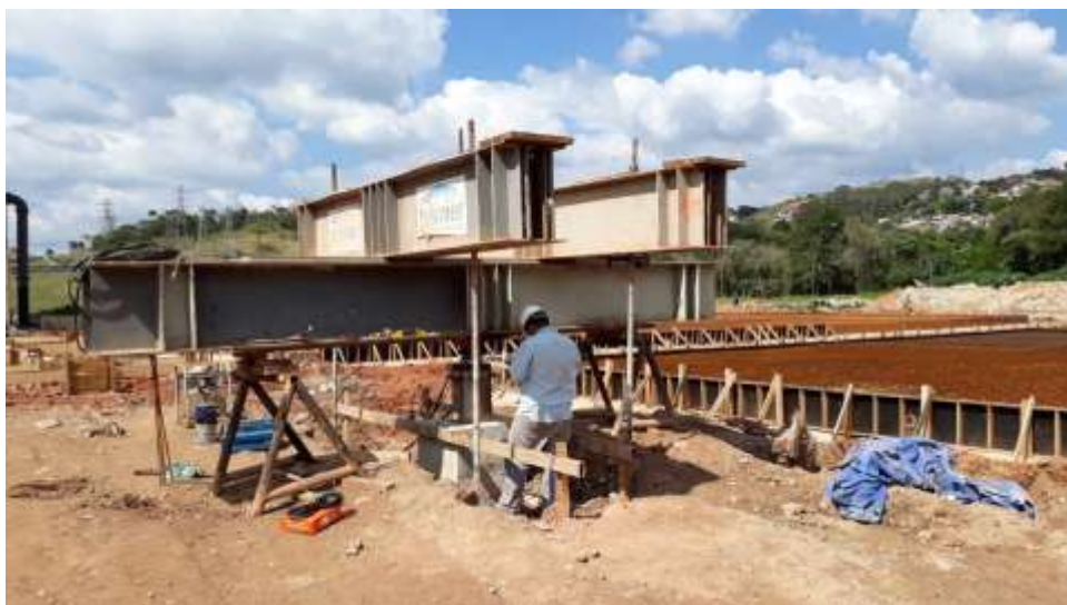
Figura 6 – Sistema de reação utilizado para a realização da prova de carga estática (Fonte: relatório nº TK-1062-REL-001-R00, Teknier (2018))
