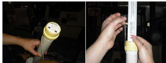
Figura 4. Aparato aplicador tampado e conferência da altura de queda (Constancio, 2010).
