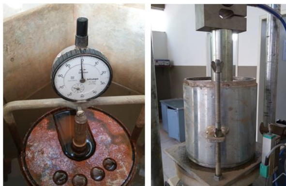
Figura 1- Leitura do extensômetro e ensaio de ruptura do corpo de prova de ISC.
