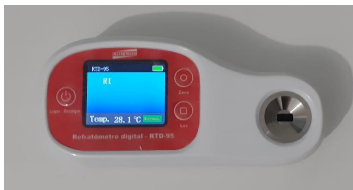
Figura 2. Refratômetro digital portátil do laboratório de Geotecnia da UnB.
