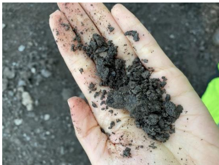
Figura 1. Mistura estabilizada com betume.
