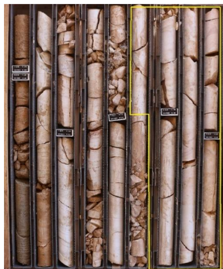
Figura 5 - Registro de testemunhos de sondagem exibindo material semi-compacto antes do intervalo destacado em amarelo de rocha compacta como demonstrado no perfil ATV.
