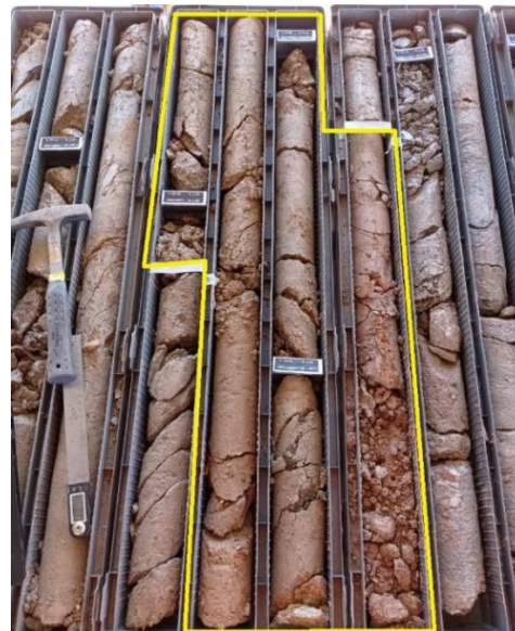
Figura 3 – Registro de testemunhos de sondagem destacando em amarelo intervalo de rocha friável como demonstrado no perfil ATV.
