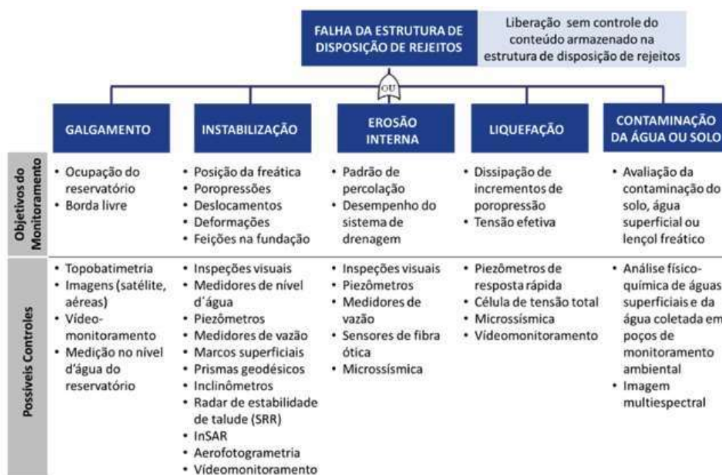
Figura 1 Monitoramento de estruturas de disposição de rejeitos (Guia de Boas Práticas do IBRAM, 2019).
