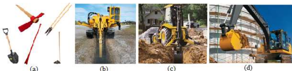
Figura 1 – (a) Pá, enxada, picareta e cavadeiras; (b) valadora; (c) retroescavadeira; (d) escavadeira hidráulica, adaptado de Francisco de Paula, 2021.
