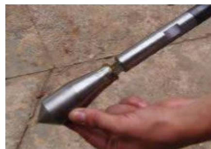
Figura 2. Ponta do DPL para penetração no solo.
