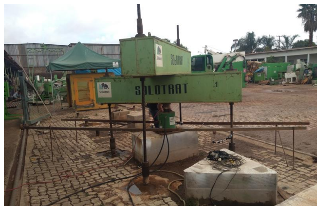
Figura 3. Prova de carga no campo experimental da Solotrat
