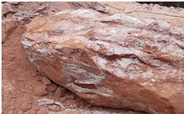
Figura 12. Quartzito constante na parede de escavação.
