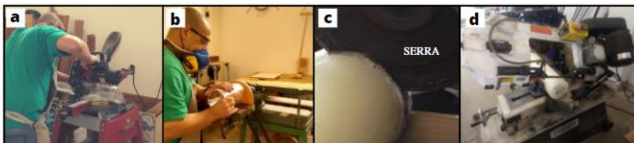
Figura 3. (a) Corte do acrílico; (b) Polimento do acrílico; (c) Tentativa de corte do tarugo de polipropileno sem sistema de resfriamento; (d) Corte do tarugo com sistema de resfriamento.
