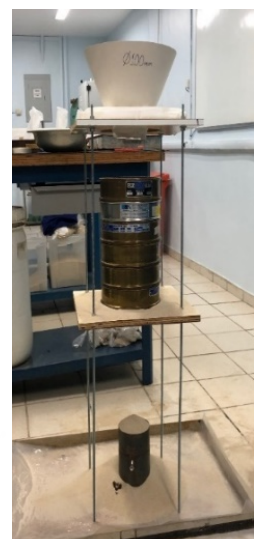
Figura 1. Esquema do método de pluviação sobre peneiras conforme Costa (2020).
