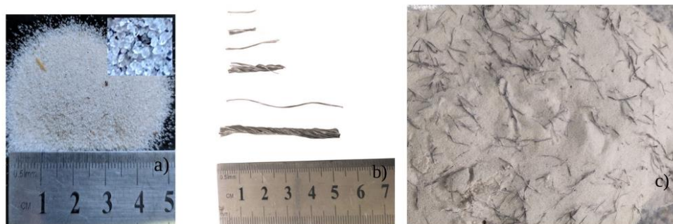
Figura 1. (a) Areia estudada. (b) Fibra nos comprimentos de 12,5mm, 25mm e 51mm. (c) Mistura solo fibra.
