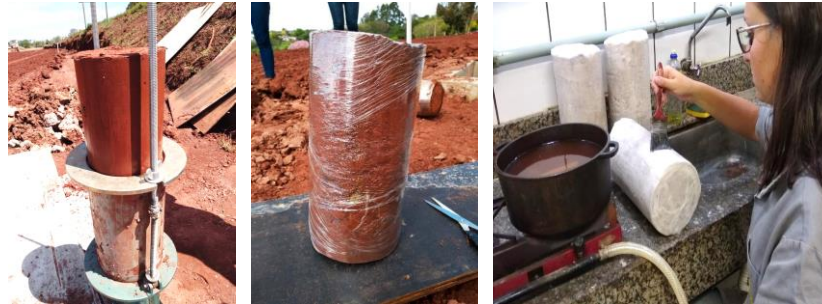
Figura 4. Extração, corpo de prova envolto em plástico filme e protegido com parafina.
