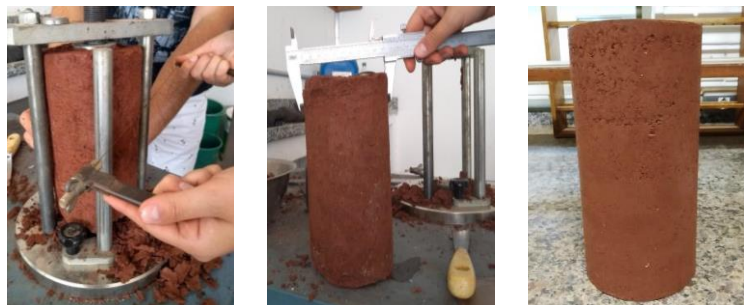
Figura 5. Procedimento de redução das dimensões da amostra.
