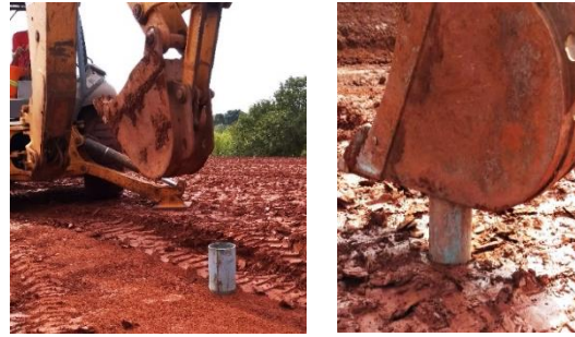
Figura 3. Amostrador cilíndrico de aço e processo de cravação do amostrador.
