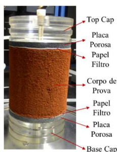
a) Preparação do corpo de prova (b) Corpo de prova durante o ensaio Figura 3. Disposição do corpo de prova para realização do ensaio.
