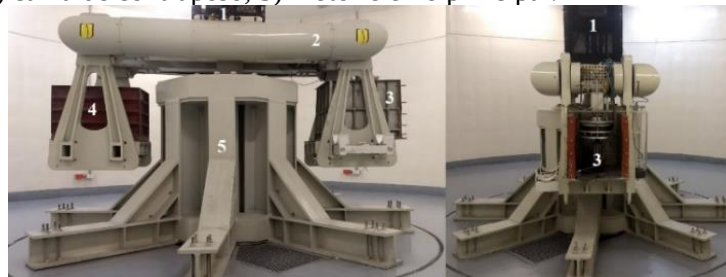
Figura 4. Centrífuga geotécnica utilizada nos modelos físicos 30g.
