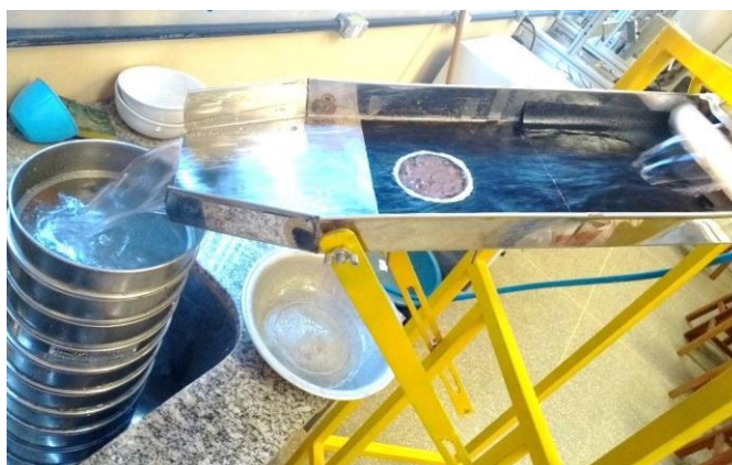
Figura 1. Ensaio de Inderbitzen em andamento.
