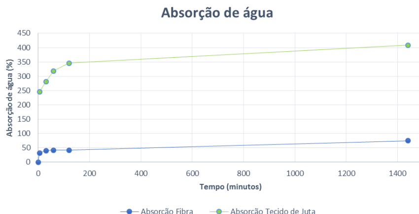
Gráfico 1. Comparação da absorção de água na fibra de coco babaçu e no tecido de juta. Fonte: Autor, 2021.
