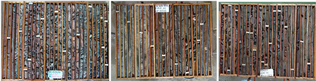
Figura 5: Representação da Falha Leste: à esquerda, na região próxima à superfície cota +320 (FC5304), ao centro representa a falha vertical paralela à mineralização no aprofundamento na cota - 953 (FC40134) e à direita a falha bifurcada na cota -1060 (FC42253) indicando maior grau de fraturamento.
