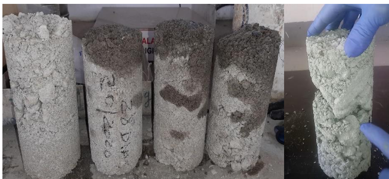
Figura 4: Demonstração dos corpos de prova após implementação do britador cônico (à esquerda) e antes do britador cônico (à direita) representando casos de segregação e má distribuição granulométrica.
