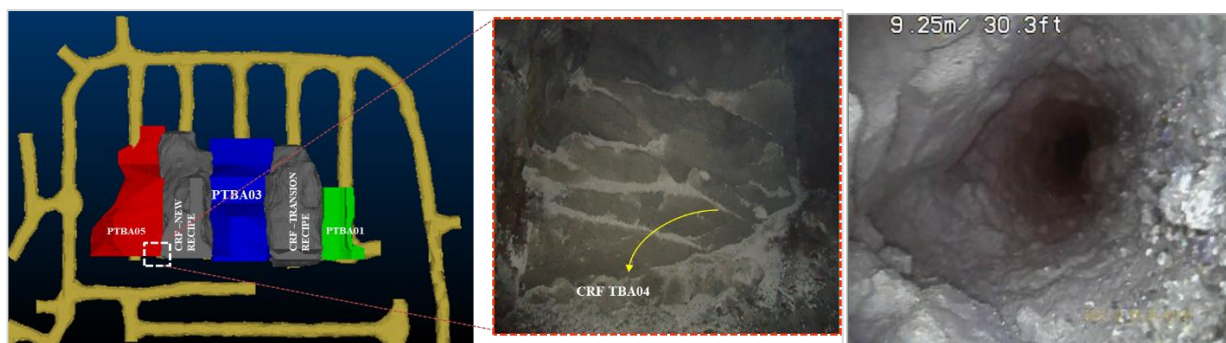
Figura 7: Face da travessa exposta (à esquerda) demonstrando a coesão e capacidade autoportante da face exposta e filmagem do furo via borehole camera (à direita) indicando preservação das paredes do furo e coesão do material.
