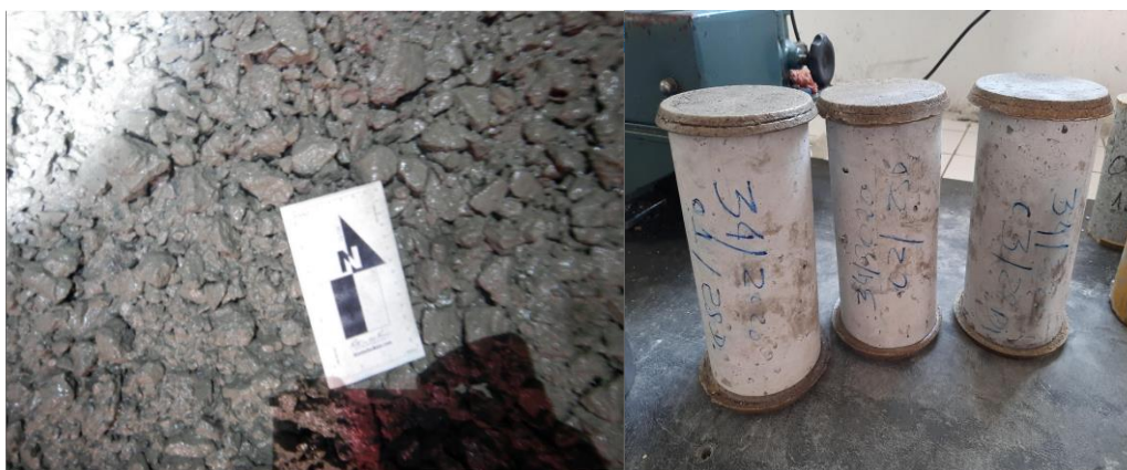
Figura 6: Material do enchimento pós mistura (à esquerda) com razão água/cimento de 1.8 em teste na planta e corpos de prova com 28 dias de cura (à direita).
