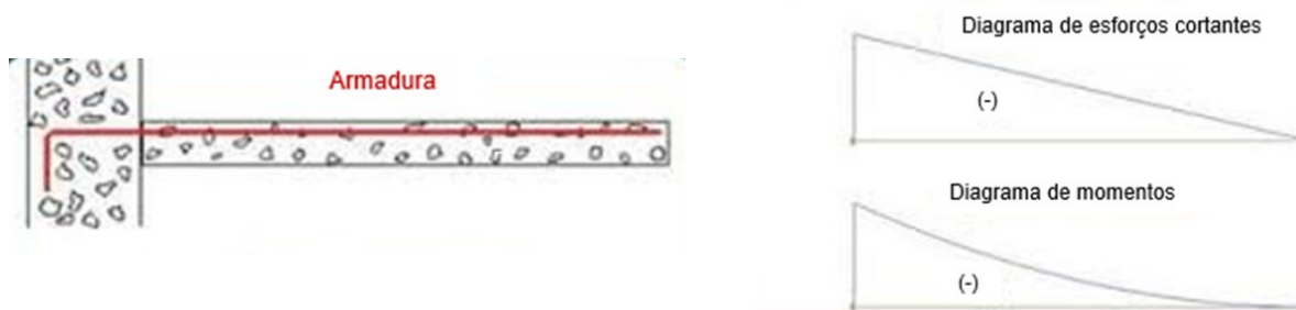
Figura 2. Esforços atuantes em uma estrutura em balanço
