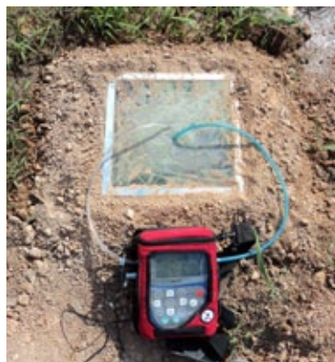
Figura 1 - Vista do GEM2000 conectado a placa na cobertura
