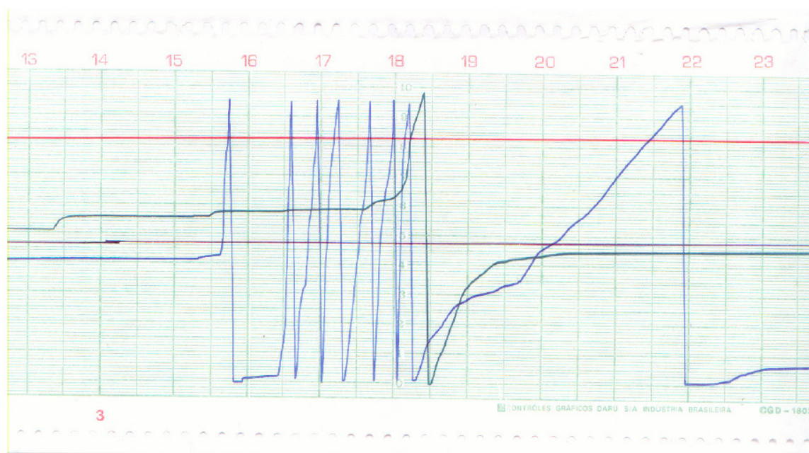
Figura 2 – Trecho representativo da leitura de um pluviograma. Fonte: DAEE/SP.
