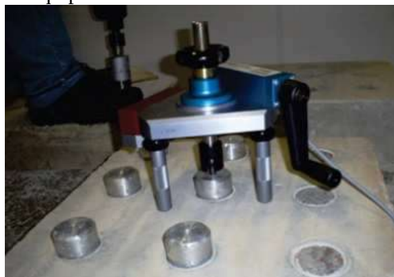
Figura 7 – Equipamento utilizado no ensaio de arrancamento.
