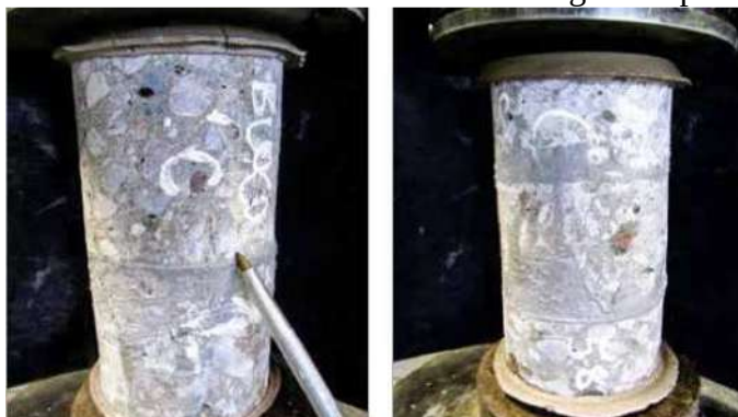
Figura 13 – Testemunhos confeccionados com colagem de partes extraídas.
