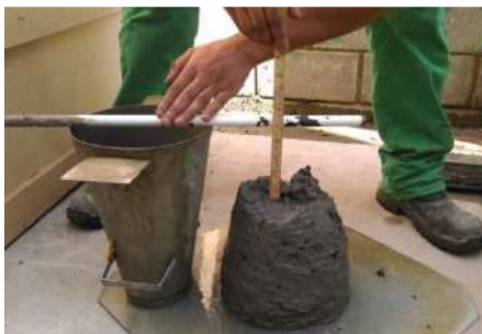
Figura 25- Ensaio de abatimento do tronco de cone (slump test).
