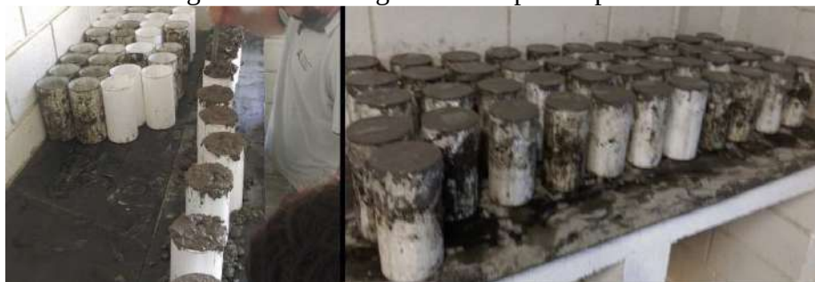
Figura 29 – Moldagem dos corpos de prova.
