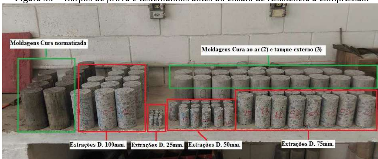
Figura 35 – Corpos de prova e testemunhos antes do ensaio de resistência à compressão.
