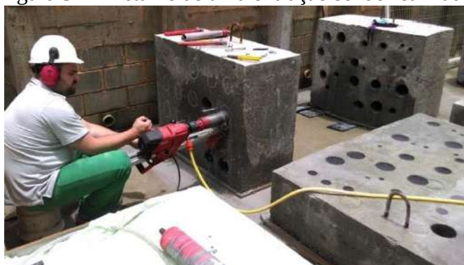
Figura 32 – Detalhe de uma extração sendo realizada.
