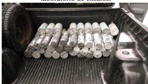
Figura 33 – Acondicionamento dos corpos de prova e testemunhos para traslado até o laboratório de ensaios.
