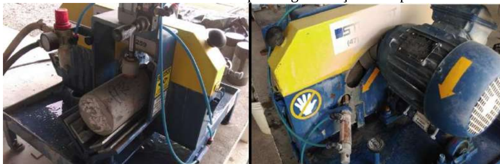
Figura 34 – Retífica automatizada utilizada para regularização de superfície das amostras.
