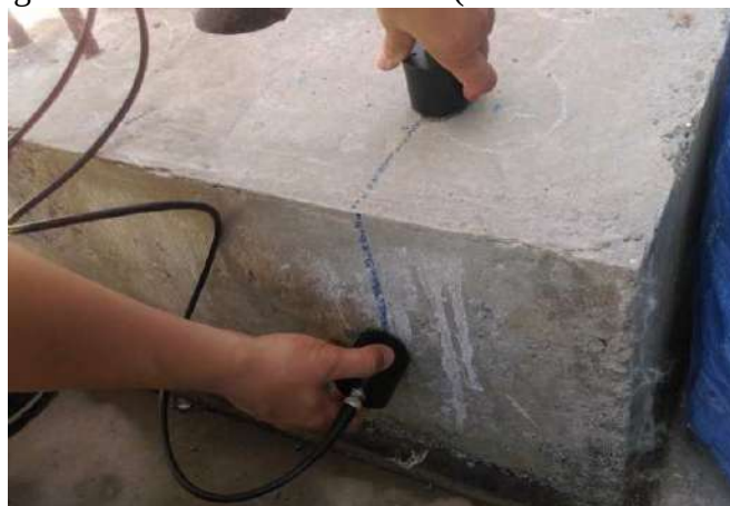
Figura 39 – Ensaio de ultrassom (método semi-direto).
