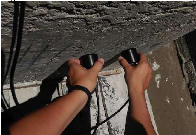
Figura 38 – Ensaio de ultrassom (método indireto).
