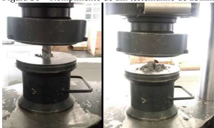
Figura 36 – Rompimento de um testemunho de 25mm.
