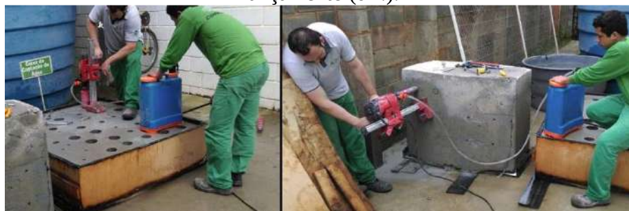
Figura 31 – Extrações de testemunhos na direção do lançamento (esq.) e ortogonal ao lançamento (dir.).
