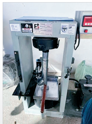
► Figura 4 Detalhe da medição da deformação uso do bloco de gesso
