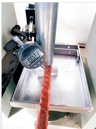
► Figura 2 Detalhe da prensa com extensômetro
