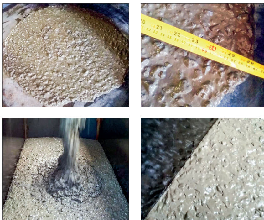
FIGURA 5 ASPECTO DO CONCRETO AUTOADENSÁVEL SF 1
