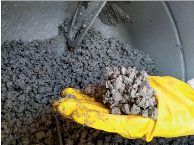
FIGURA 1 ANÁLISE VISUAL DO CONCRETO PERMEÁVEL FONTE: AUTORIA PRÓPRIA (2023)
