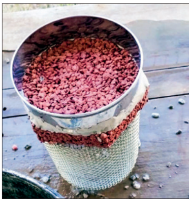
FIGURA 7 ENSAIO DE INFILTRAÇÃO AOS 28 DIAS FONTE: AUTORES (2023)
