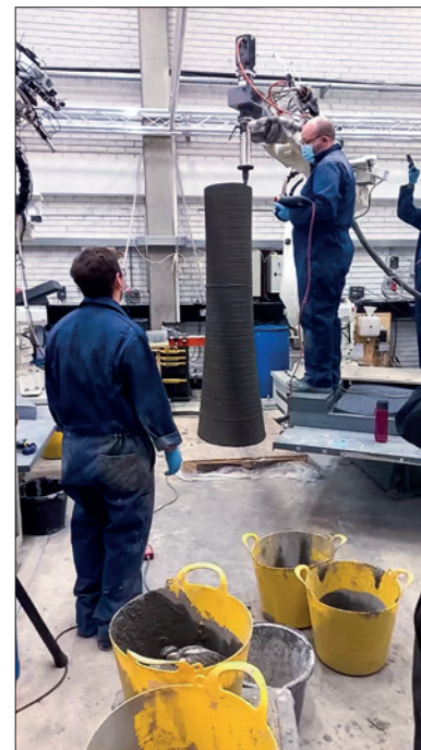
FIGURA 2 IMPRESSÃO 3D DE COLUNA UTILIZANDO BRAÇO ROBÓTICO INDUSTRIAL, EM PESQUISA LIDERADA PELO PROF. RICHARD BUSWELL, UM DOS PIONEIROS DESSE CAMPO, NA UNIVERSIDADE DE LOUGHBOROUGH, INGLATERRA FONTE: AUTORES
