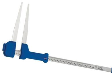
Figura 2.2. Suta mecânica de alumínio (Fonte: Haglöf, 2022).
