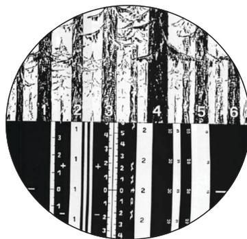
**Figura 2.42.** Porção da escala do relascópio contida na metade inferior do campo visual e a metade superior na qual se observa a paisagem (Fonte: Barreiro et al., 2004).
