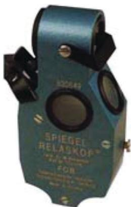
**Figura 2.41.** Relascópio de espelho de Bitterlich (Fonte: Barreiro et al., 2004).
