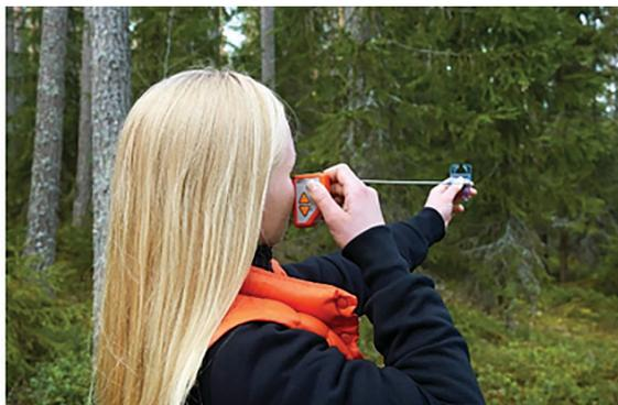
**Figura 2.43.** Clinômetro eletrônico EC II D-R e exemplo de manuseio do instrumento (Fonte: Haglöf, 2022).
