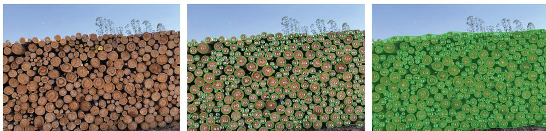
**Figura 2.25.** Imagem fotográfica tirada com aparelho celular e utilizada para determinação indireta do fator de empilhamento (Fonte: Timbeter, 2022).
